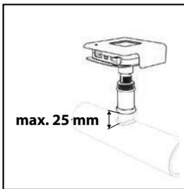
**OPGELET! Maximale lengte van 25 mm, sondetip moet goed ompoeld zijn.**
